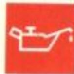
Insufficiente pressione olio motore
