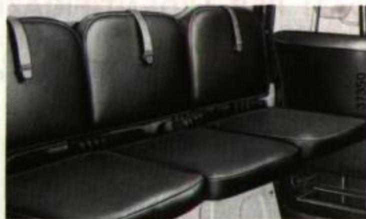
I sedili posteriori, asportabili, sono fissati alle pareti tramite viti, e ai passaruote tramite le viti A sulle longherine inferiori dell'ossatura degli schienali.
