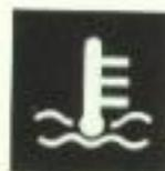
Temperatura liquido refrigerante motore
