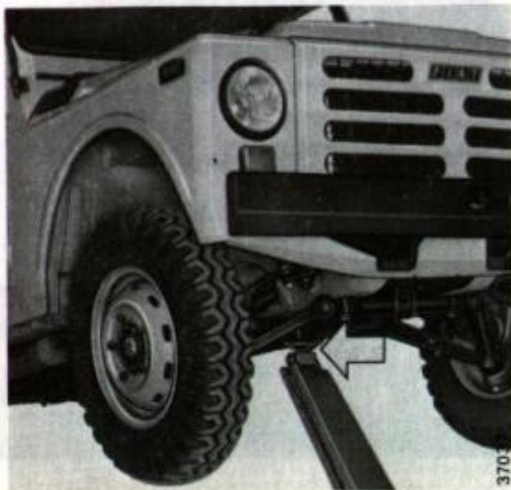
Per sollevare il veicolo dalla parte anteriore disporre l'estremità del sollevatore sotto la traversa della sospensione anteriore.
