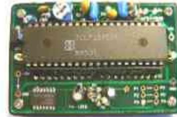
Afficheur intégré utilisé dans ce montage, lequel est entièrement configurable, aussi bien en ampèremètre qu'en voltmètre.
