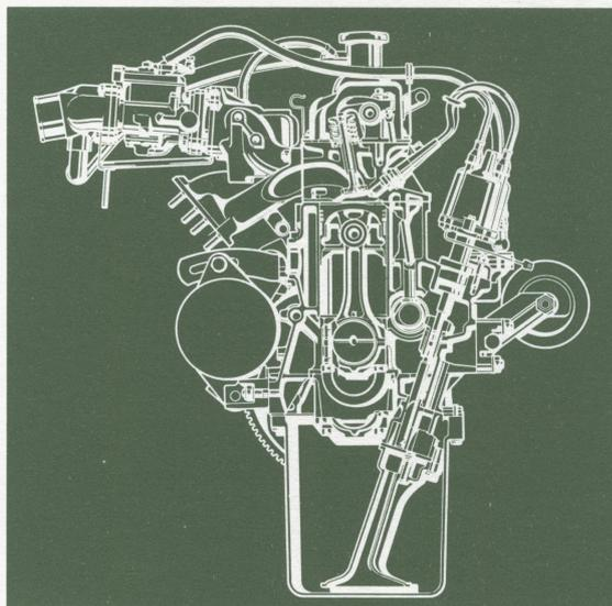
*E' un quattro cilindri in linea con cinque supporti di banco. Si tratta di un propulsore ampiamente collaudato che ha già dimostrato le sue doti di robustezza e affidabilità in vari modelli della produzione Fiat.*
